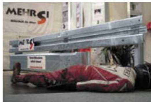
Die Bepunktung verhindert auch das Durchrutschen unter der Leitplanke
